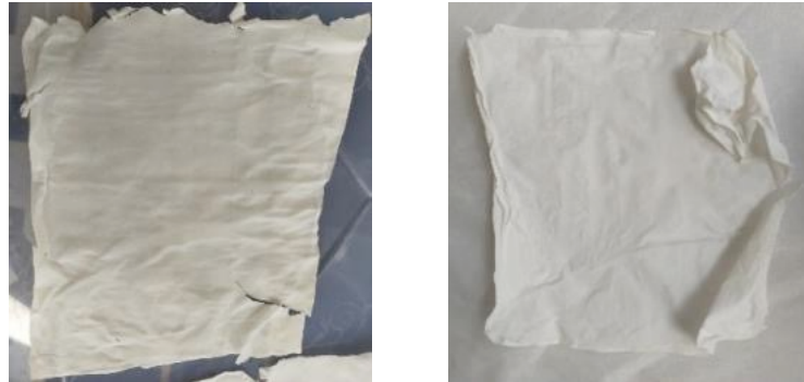
Gambar 2 Membran Selulosa TKKS Menggunakan Pelarut (a) NMP, (b) DMAc
